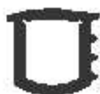
BURLETE PARA VIDRIO LAMINADO 3+3mm. Ó ESPEJO Código AG-090E
